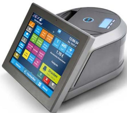
IVU.ticket.box est la centrale de commutation numérique dans le bus. L'ordinateur de bord intégré saisit toutes les procédures, communique avec le poste de commande, imprime les titres de transport et valide les billets électroniques..
